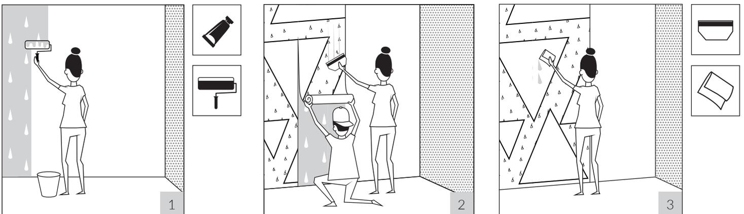
1. Instala la impresión empezando por la esquina izquierda de la habitación, ventana o puerta. Para pegar la primera lámina en una columna verticalmente perfecta, puedes ayudarte trazando una línea vertical en la pared. Aplica el adhesivo en la pared bajo la primera lámina.
